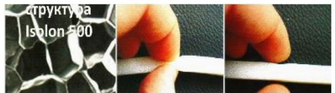
Структура Isolon 500 и Isolon 300 при нагрузках восстанавливается.
