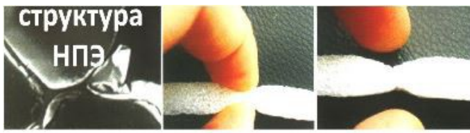
Структура НПЭ любой марки при нагрузках при нагрузках не восстанавливается.
